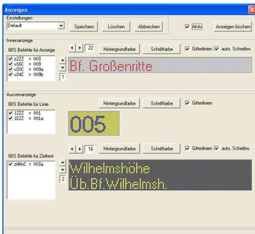
Es können die VDV-Befehle ausgewählt werden, die für Anzeigensteuerung versendet werden. Getrennt nach den drei Anzeigenarten Innenanzeige, Liniennummer und Zielanzeige werden die Texte, die mit Befehlen auf dem IBIS Wagenbus gesendet werden, angezeigt. Die Anzeigen sind mit Hintergrundfarbe, Textfarbe, Zeilen und Spaltenzahl parametrisierbar. Die Parametrisierung ist speicherbar, so dass unterschiedliche Anzeigentypen in einem Anzeigenarchiv abgelegt werden können, das bei Bedarf ladbar ist.
