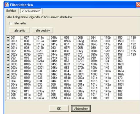
Für die Einstellung des Filters ist es entweder möglich, Kategorien (nach VDV) von Befehlen auszuwählen, wie z.B. die Befehle für die Anzeigen. Weiterhin ist es möglich, jeden einzelnen Befehl direkt anzugeben, der gefiltert oder in die Anzeige gebracht werden soll.
